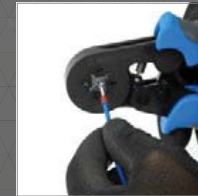
A nagy precíziású sajtolópofák a szorítóhüvelyt mindig pontosan a megfelelő formára préselik.
