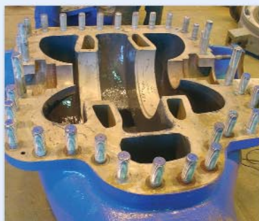
4. kép: A teljes felület bevonásra került, a részleges kikeményedés után egy második védőréteg is felvitelre került
