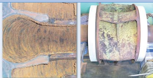
A fedél és a bronz járókerék a felújítás előtt. Az első lépés SA-3 minőségű szemcseszórás a 75 µm-es felületi profil biztosítása érdekében.
